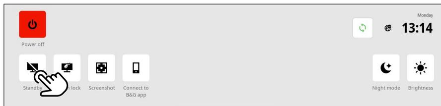
→ **Remarque** : La touche Arrêt à l'écran n'est pas disponible lorsque l'appareil est commandé par un commutateur externe ou d'autres appareils.
