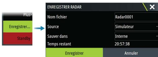
Vous pouvez enregistrer les données de radar et les sauvegarder en interne dans l'appareil ou sur un périphérique de stockage connecté à l'appareil.
