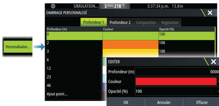
Dans l'exemple suivant, une profondeur d'eau de 5 à 10 mètres est représentée par une nuance de jaune sur la carte lorsque Depth 1 est la nuance sélectionnée dans le menu.
