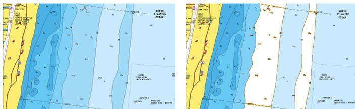
*Sans échelle de profondeur en surbrillance*      *Échelle de profondeur en surbrillance : 6 m - 12 m*
