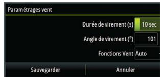
Cette option permet de modifier manuellement des paramètres qui ont été définis lors de la mise en service du calculateur de pilote automatique. Pour plus d'informations sur les paramètres, reportez-vous à la documentation spécifique pour le calculateur de pilote automatique.
