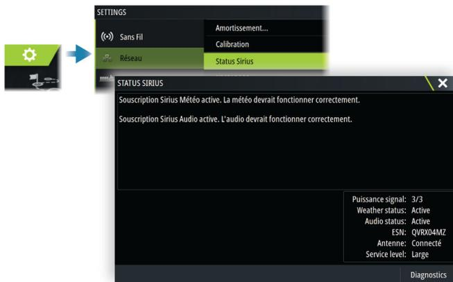
La fenêtre d'état montre la puissance du signal comme suit : 1/3 (faible), 2/3 (bonne) ou 3/3 (excellente). Elle inclut également l'état de l'antenne, le niveau de service et le numéro de série électronique du module météo.
